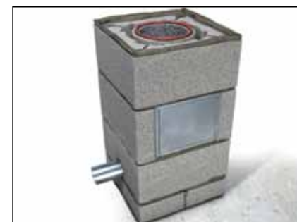
Innerrøret (pipeforingen) har påmontert en støttering som sørger for å holde den riktige avstanden til ytterelementet.
