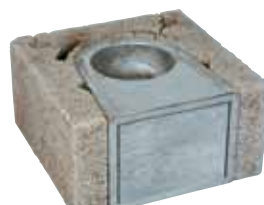
Sotlukeelement Med innstøpt feieluke Mål: 46x46x25 cm Vekt: 35 kg Betegnelse: P-21
